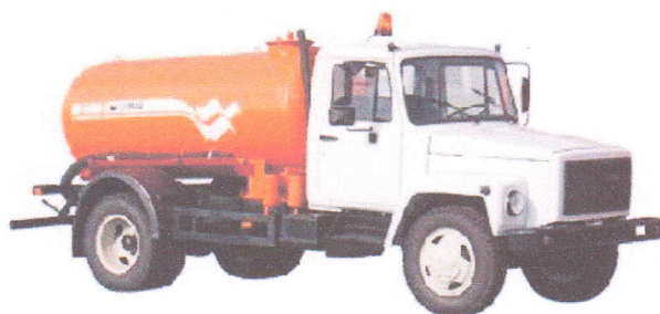
Рис. 5.4. Вакуумная машина КО-503В-2 на шасси ГАЗ-3309
