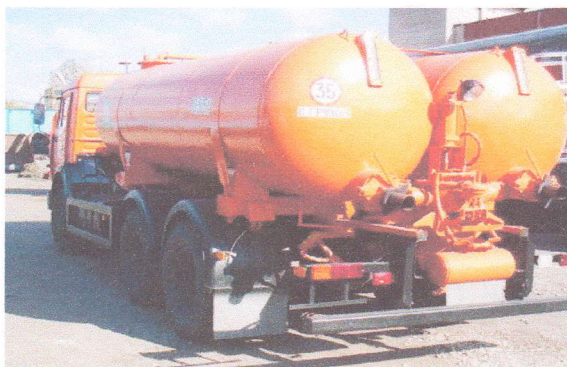
Рис. 5.5. Вакуумная машина КО-505А на шасси КамАЗ-65115-71
