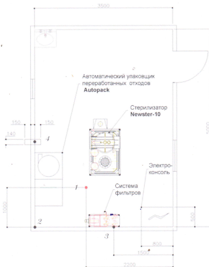
Рис. 8.3. Схема размещения технологического оборудования в помещении
