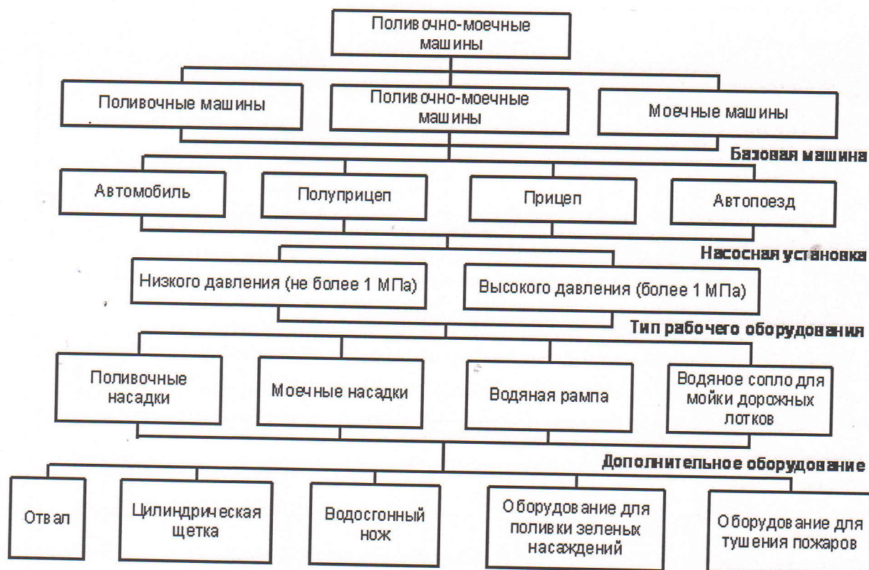
Рис. 6.9. Классификация поливочно-моечных машин
