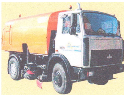
Рис. 6.12. Вакуумная подметально-уборочная машина ВПМД-01.
